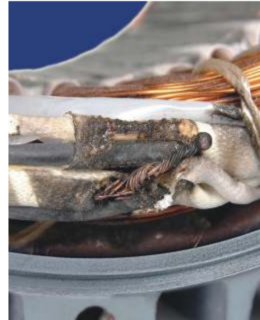
DESBALANCEAMENTO DE TENSÃO
